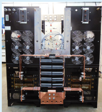
100 V 2 500 A (250 kW) pulsé à 250 Hz
